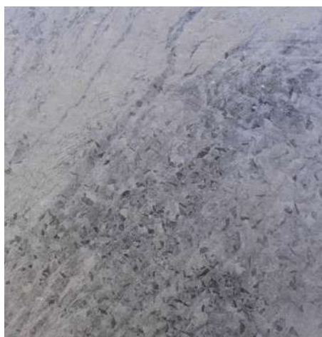
Acier galvanisé à chaud avec passivation
